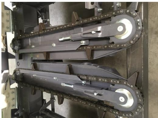
**Саморегулируемые и самоочищающиеся натяжители цепи** (в базе) имеют большую пружинность и всегда гарантируют отличное натяжение, что предохраняет цепь от разрывов. Таким образом, натяжение цепи не нуждается в постоянной регулировке.
